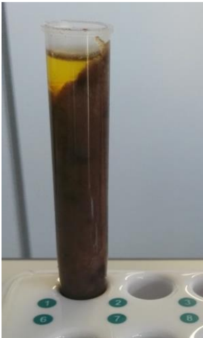
Figura 1. Estrazione sostanza grassa con il sistema CDR FoodLab®
