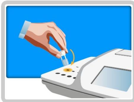
**14.** Inserire la cuvetta in una cella di incubazione ed avviare il timer premendo sull'icona.
