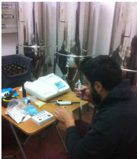
Figura 3. Fase di analisi dei prodotti per mezzo dello strumento CDR BeerLab®, collocato in Laboratorio nel locale di fermentazione
